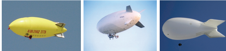
Fig. 7.21: Non rigid airship
